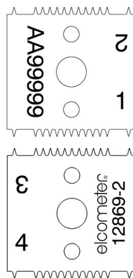
*Note : La norme ISO/JIS préconise de remplacer l'outil de coupe lorsque le sommet des lames présente un aplatissement de 0.1 mm.*
