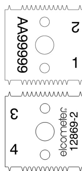
注: ISOとJIS規格では、刃先の幅が0.1mmになつたら取り替えるように指示しています。
