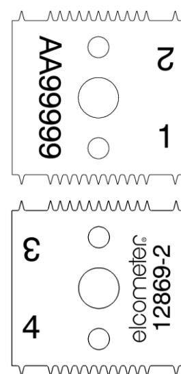
*Hinweis: Die ISO/JIS-Norm empfiehlt den Austausch des Schneidwerkzeugs, wenn die Schneidkante auf 0,1 mm abgeflacht ist.*
