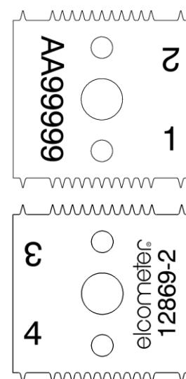
*Opmerking: Volgens de aanbevelingen van de ISO/JIS standaard moet u de messen vervangen als de bovenkant van de roosterkammessen is afgevlakt tot 0,1 mm.*
