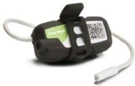
■ **SYSTÈME DE SURVEILLANCE À DISTANCE DE LA TEMPÉRATURE ET MATURITÉ DU BÉTON**
