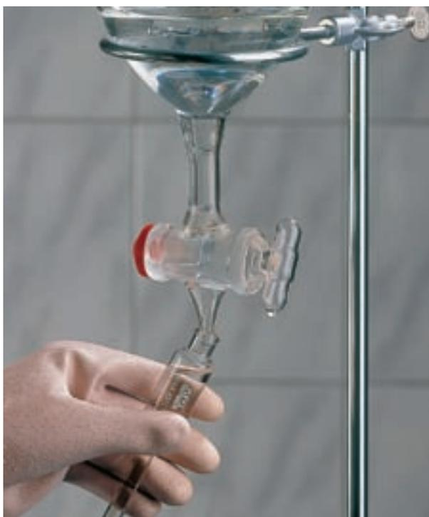
Ill. 1 Porter des gants et des lunettes de protection lors du remplissage de l'acide sulfurique
