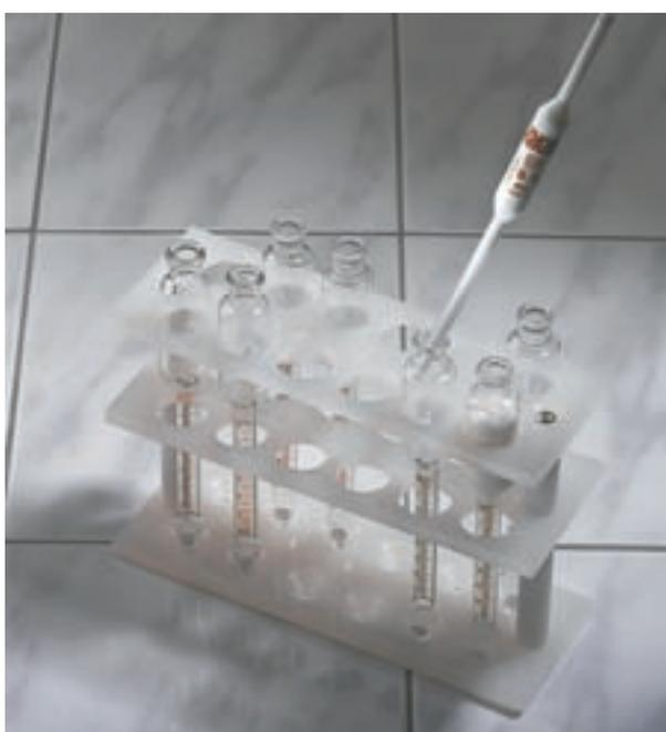
Ill. 2 10,75 ml de lait sont introduits dans le butyromètre à l'aide d'une pipette
