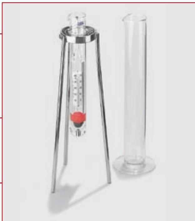
**Statif**Avec suspension à cardan, cylindre
