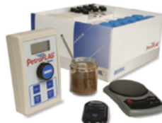
Ensembles de détection des hydrocarbures
