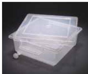
Ce plateau pour coloration en polypropylène permet de colorer, fixer, décolorer et manipuler les gels et les membranes fragiles pour l'électrophorèse. Le plateau de même que le couvercle résistent aux températures entre -70°C et 70°C. Le bouchon en polyéthylène basse densité étanche permet un drainage facile du liquide. Poids : 0,1 kg ; dimensions : 13 cm x 13 cm x 5 cm
