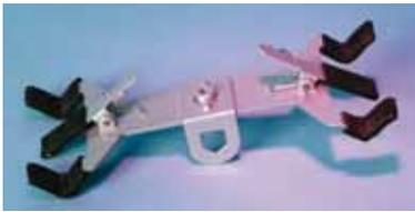
Ces pinces possèdent des mâchoires à ressort revêtues de plastique. Elles conviennent aux burettes ayant un diamètre extérieur maximal de 35 mm et aux tiges de support de 1,3 cm de diamètre maximal.
