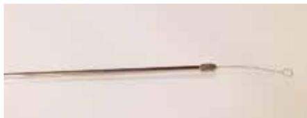
Cette anse est faite d'un fil de nickel-chrome de calibre 24 et de 8 cm et d'un manche en acier solide de 20 cm.
