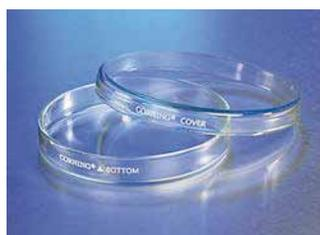
Ces boîtes de Pétri plates et transparentes de marque Pyrex Vista sont fabriquées de verre sodocalcique et peuvent supporter de nombreuses stérilisations (sèche ou humides). Les bords sont renflés pour plus de résistance et pour permettre une égalité entre l'espace de la paroi du fond et du couvercle, réduisant ainsi la capillarité
