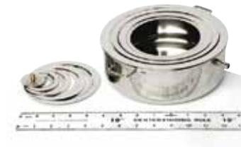
Dimensions (8" x 2 3/4"), ce bain-marie est idéal pour chauffer des fioles, des flacons, des éprouvettes, etc. Fait d'acier inoxydable robuste, il comporte sept anneaux concentriques, un fond plat et une tubulure d'échappement de vapeur. Poids total : 0,7 kg.
